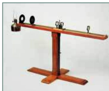
Fig.1 ► The first fociometer or lensmeter (Tonkelaar, Henkes, van Leersum 1996)
